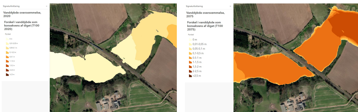
Figur 27 Forskel i vanddybde som konsekvens af sluse i drift ved jernbanekrydsning over Kolding Å ved en 100-års hændelse i nutid hhv. år 2075. I nutiden vil forskellen være negligerbar (under 5 cm), men i 2075 klimaet vil forskellen være 1,3 m.
